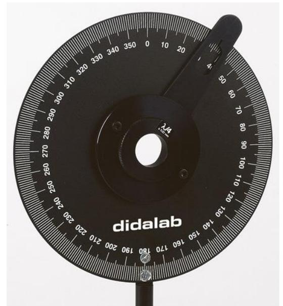
Remarque : Les lames dont on dispose en TP fonctionnent de manière optimale à une longueur d'onde de  $633 \text{ nm}$ . C'est la longueur d'onde du laser He-Ne. Ces lasers sont chers, et nous travaillerons essentiellement avec des diodes laser à  $650 \text{ nm}$ .
