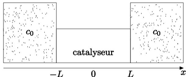
La réaction chimique étant supposée d'ordre 1, dans un volume  $dV$  du catalyseur situé en  $x$ , il disparaît une quantité  $\delta N_A = c(x) dV \frac{dt}{\tau}$  molécules  $A$  dans une durée  $dt$ ,  $\tau$  désignant un temps caractéristique lié à la réaction.
