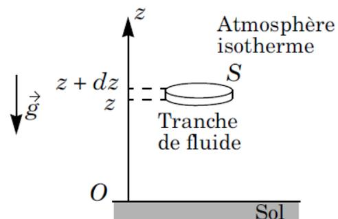
**Figure 1** : tranche de fluide dans le modèle de l'atmosphère isotherme
