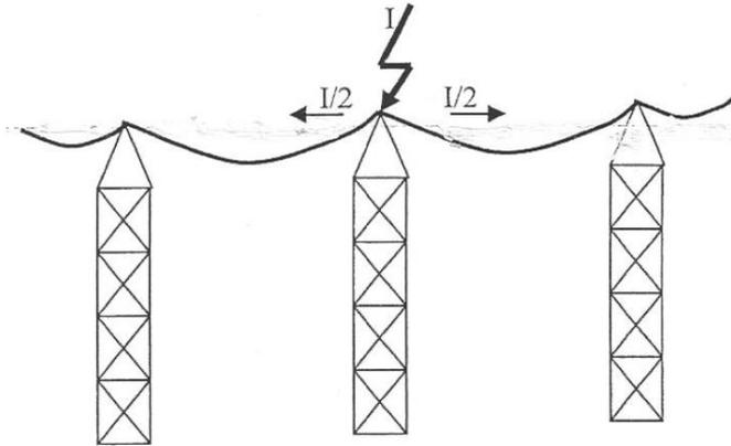
Figure 6 - Impact direct sur une ligne électrique
