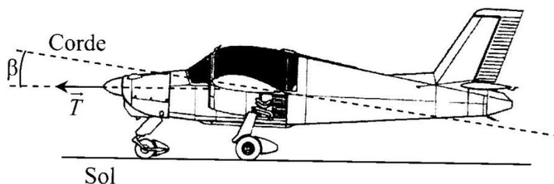
3. a) Dans la phase de roulage précédant l'instant du décollage, le pilote tire momentanément sur le manche de sorte que la queue de l'avion s'enfonce. L'avion étant à charge maximum, à quel angle  $\delta$  le pilote doit-il choisir de placer l'axe longitudinal de l'avion par rapport au sol ? Faire un schéma en représentant les forces s'exerçant sur l'avion et le vent relatif à l'infini. Quelle est la vitesse minimum à l'instant où les roues quittent le sol ?
