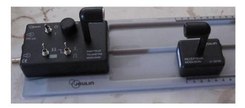
On dispose d'un émetteur d'ultrasons (gauche photo), et de plusieurs récepteurs (un à droite photo). L'émetteur doit être alimenté par une tension continue de 15V pour fonctionner. On générateur interne fournit alors un signal sinusoïdal de fréquence voisine de 40 kHz, et d'amplitude égale à qq volts. Le gros bouton noir permet de régler l'amplitude de l'onde émise.
