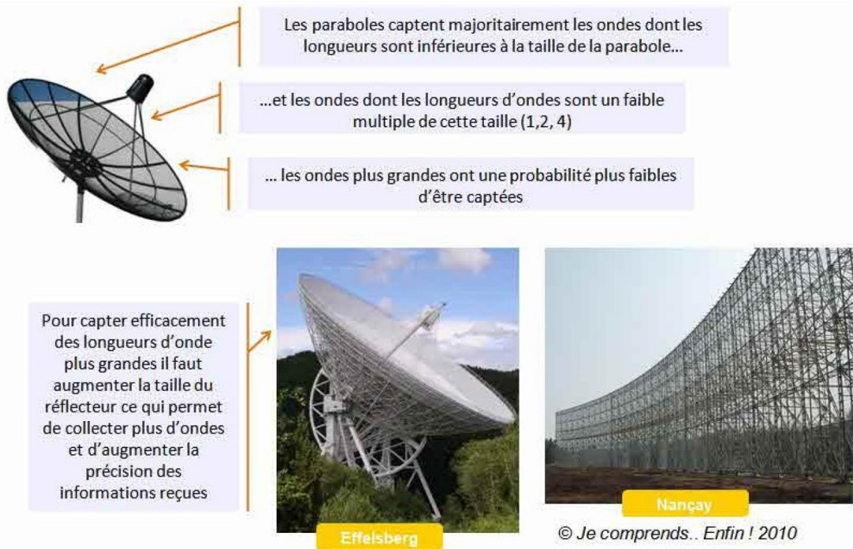
Figure 4 : Taille des antennes paraboliques. Par exemple, le radiotélescope d'Effelsberg a un diamètre de 100 m.
