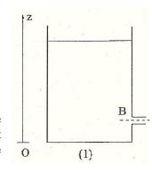
On nomme  $D_s$  le débit volumique d'eau sortant par l'orifice B associé à l'écoulement de vidange du réservoir. La surface libre du réservoir et l'extrémité de l'orifice sont en contact avec l'air. Tous les écoulements considérés sont assimilés à des écoulements homogènes et incompressibles.
