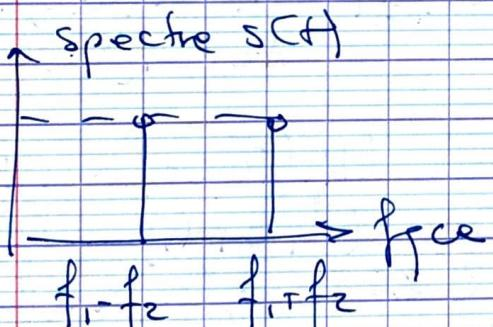
Le multic permet l'addition et de soustraire les fréquences de  $u_1$  et  $u_2$ .
