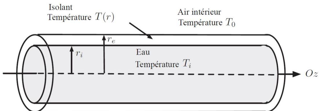
FIGURE 10 – Canalisation avec isolant.
