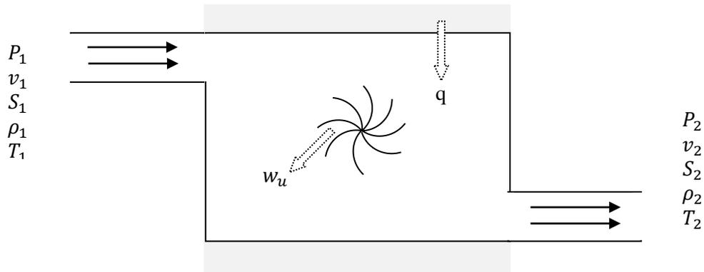
Le fluide pénètre dans une cavité, depuis une zone en amont où l'écoulement est simple et peut être modélisé comme uniforme (tous les champs sont indépendants de la position à l'intérieur de cette zone). Le fluide ressort de la cavité vers une zone en aval où l'écoulement est également simple et modélisé comme uniforme, les champs n'étant par contre pas identiques à ceux en amont. Dans le cas général, l'écoulement n'est pas stationnaire.
