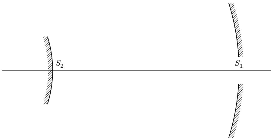
Figure 2 Un télescope unitaire du VLT en montage de type Cassegrain
