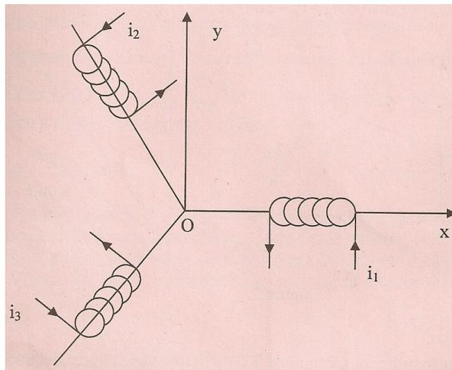
**A.1)** Donner l'expression du champ magnétique  $\vec{B}_s$  créé par le stator à l'intérieur de la machine dans la base  $(\vec{e}_x, \vec{e}_y)$ . On exprimera chaque composante en fonction de  $K$ ,  $I_m$ ,  $\omega_s t$  et  $\varphi$ .
