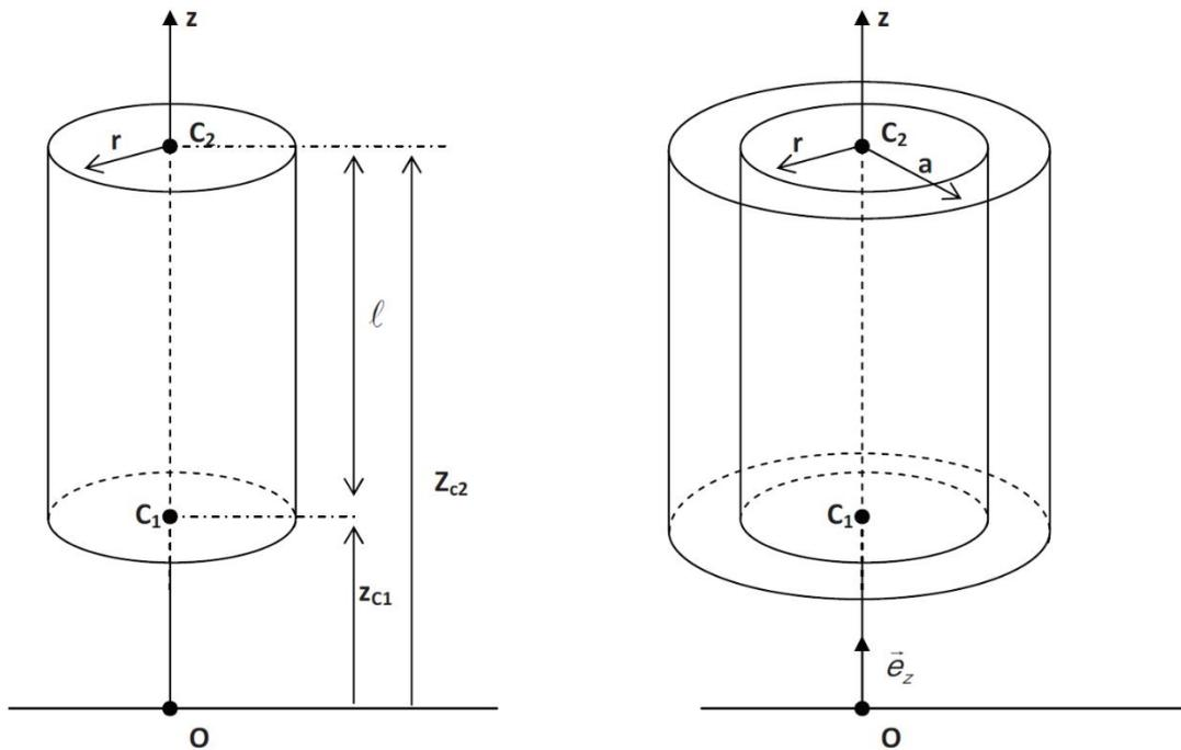
On isole par la pensée un cylindre de fluide de rayon  $r$  inférieure à  $a$  et de longueur  $\ell$ . Ce cylindre subit des forces pressantes en  $C_1$  et  $C_2$ , son poids et des forces visqueuses modélisées par la loi suivante :
