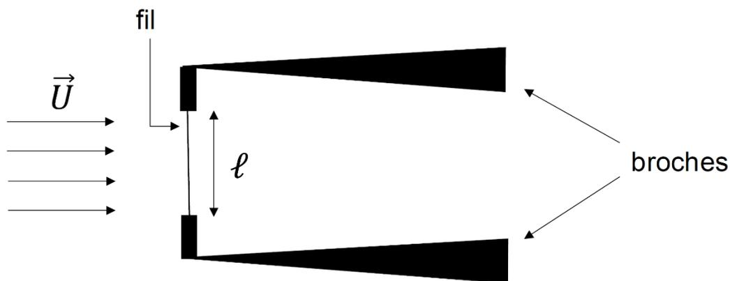
**Figure 3 - Anémomètre à fil chaud**
