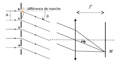
Le réseau est utilisé en spectroscopie (« voir le spectre »), car il permet de séparer spatialement les différentes longueurs d'onde de la lumière incidente. C'est une alternative possible au prisme, étudiée en TP.
