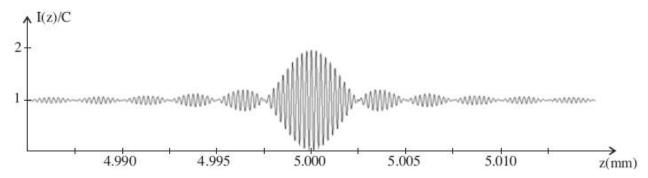
La figure ci-dessus représente l'éclairement (ou l'intensité *I*) en fonction d'un paramètre **z**, qu'on supposera repérer la position selon l'horizontale d'un point sur l'écran où sont visibles les interférences.
