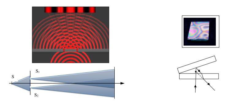
$\bullet$  Dans le cas de gauche (division du front d'onde), dessiner deux rayons (un passant par  $S_1$  l'autre par  $S_2$ ), qui se coupent en un même point de l'écran. Repérer la différence de chemin optique parcouru par ces deux rayons, entre le point d'émission et le point d'arrivée.
