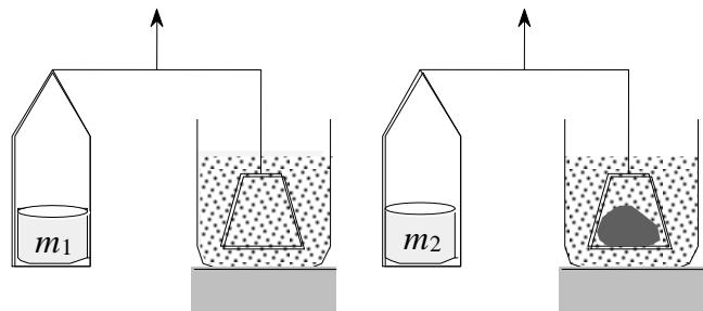
Expliciter la notion de poussée d'Archimède. Exprimer  $V_T$  en fonction de  $m_1$ ,  $m_2$ , de la masse de l'échantillon  $m$ , et de  $\mu_{\text{Hg}}$ .
