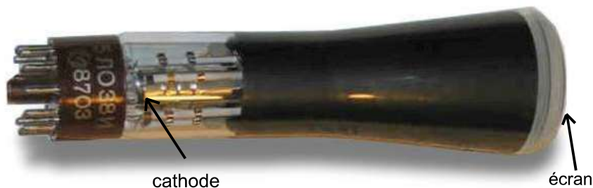
Figure 6 – Petit tube d'oscilloscope, de longueur d'environ 20 cm
