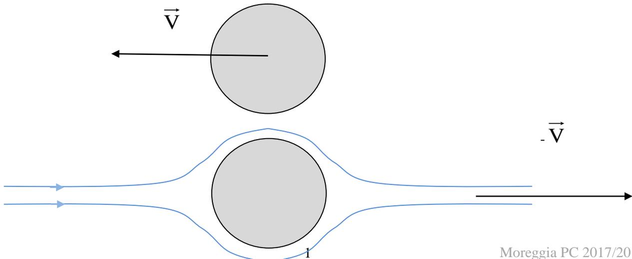
L'expérience montre que la sphère atteint une vitesse limite constante. Cela suggère l'existence d'une force autre que le poids et la poussée d'Archimède, et associée aux frottements du fluide sur la sphère (effet viscosité).
