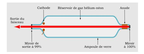
Une source laser associe un milieu amplificateur à une cavité optique, encore appelée résonateur, généralement constituée de deux miroirs, dont au moins l'un des deux est partiellement réfléchissant : une faible partie de la lumière sort de la cavité et l'autre partie est réfléchie vers l'intérieur de la cavité laser.
