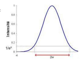
Ainsi, le spot laser (interception du faisceau par un écran) que l'on observe en TP correspond à une répartition gaussienne de l'intensité, décroissante à partir du centre du spot.
